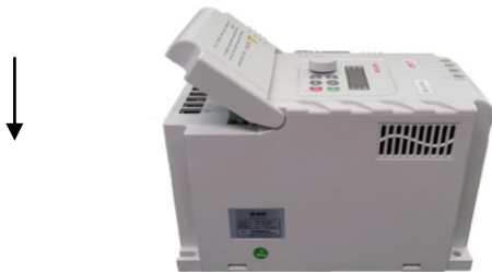
图 2- 4 安装端子外罩
